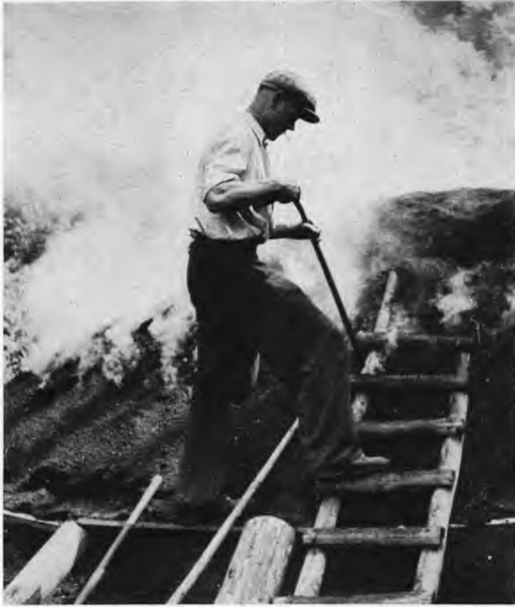
Bild 6 Prüfung des Brandes vom Laufsteg aus
